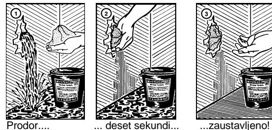
Po zaptivanju prodora, ostatak podloge treba hidroizolovati.
